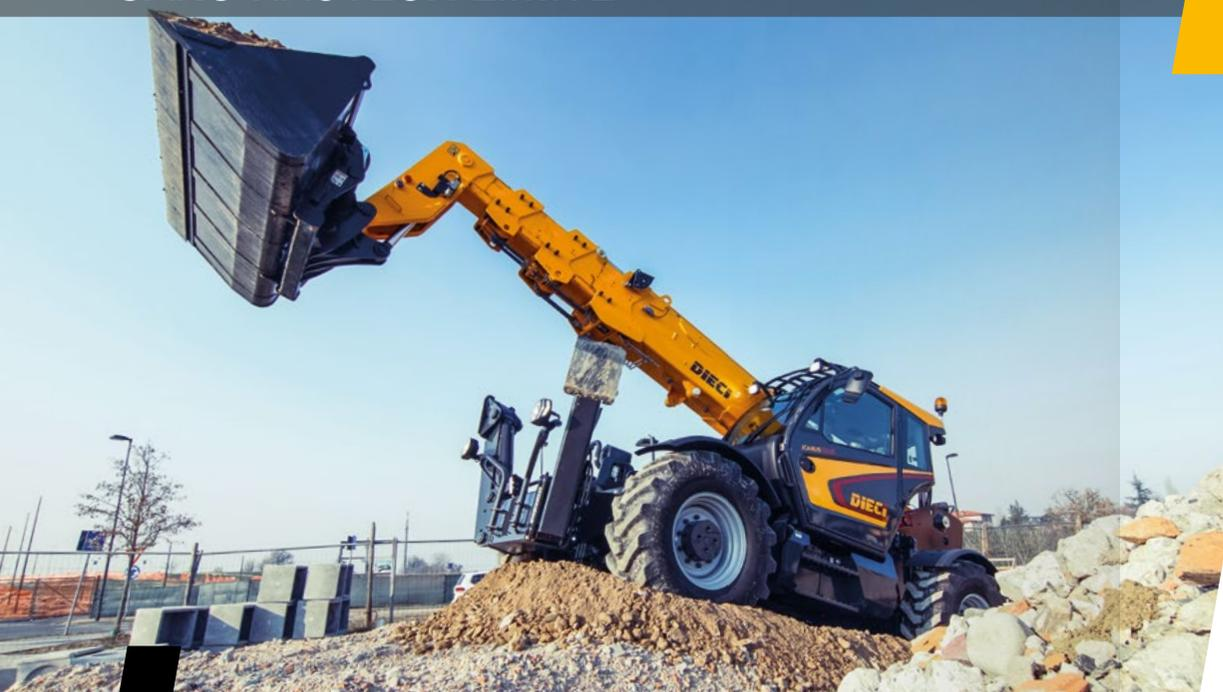
Icarus, qui fait partie de la Nouvelle Gamme BTP, est la machine qui voit haut : le bras se déploie **jusqu'à 18 mètres** tout en conservant un **équilibre parfait** grâce aux stabilisateurs indépendants.
