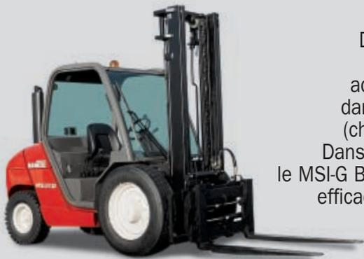
MSI 30 D avec positionneur de fourches
